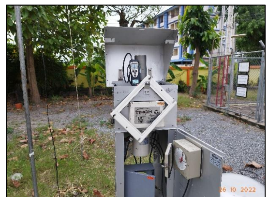
รูปที่ 3-3 การเก็บตัวอย่างคุณภาพอากาศในบรรยากาศ บริเวณ วัดอุ้มตะเกา
